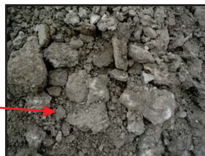
Detalle del yeso alterado.
