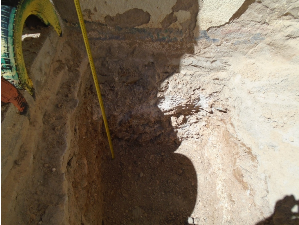
Foto 7: Calicata manual C-1, en el interior del arenero y próxima al muro del eje C. Se aprecia el hormigón con cantos en estado sano hasta una profundidad de 40 cm, a partir de la cual aparece hormigón pobre hasta 70 cm.
