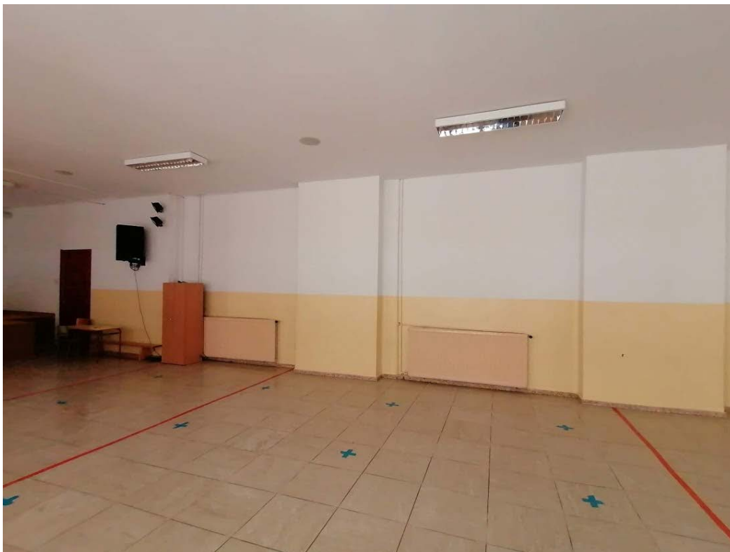
Foto 17: Primera planta. Tabiques a retirar para apertura de huecos en el salón multiusos y biblioteca o sala de lecturas. Se afectará al circuito y a los radiadores de la calefacción.
