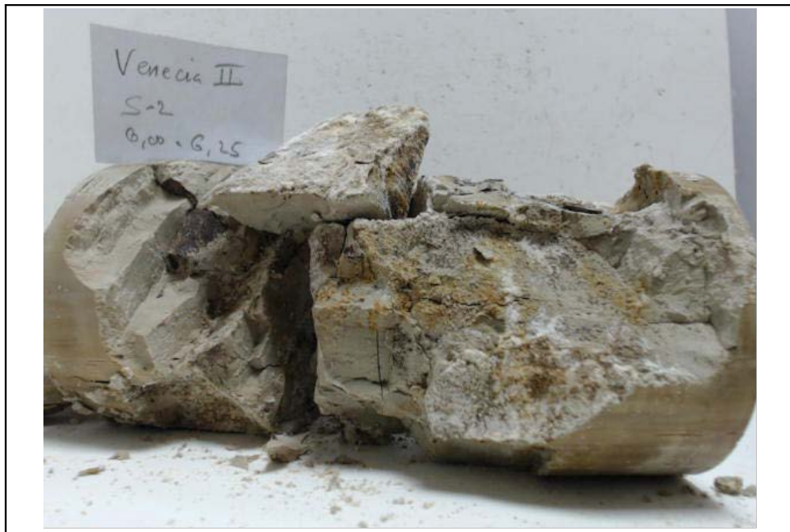
Fragmentos de la probeta tras la rotura
