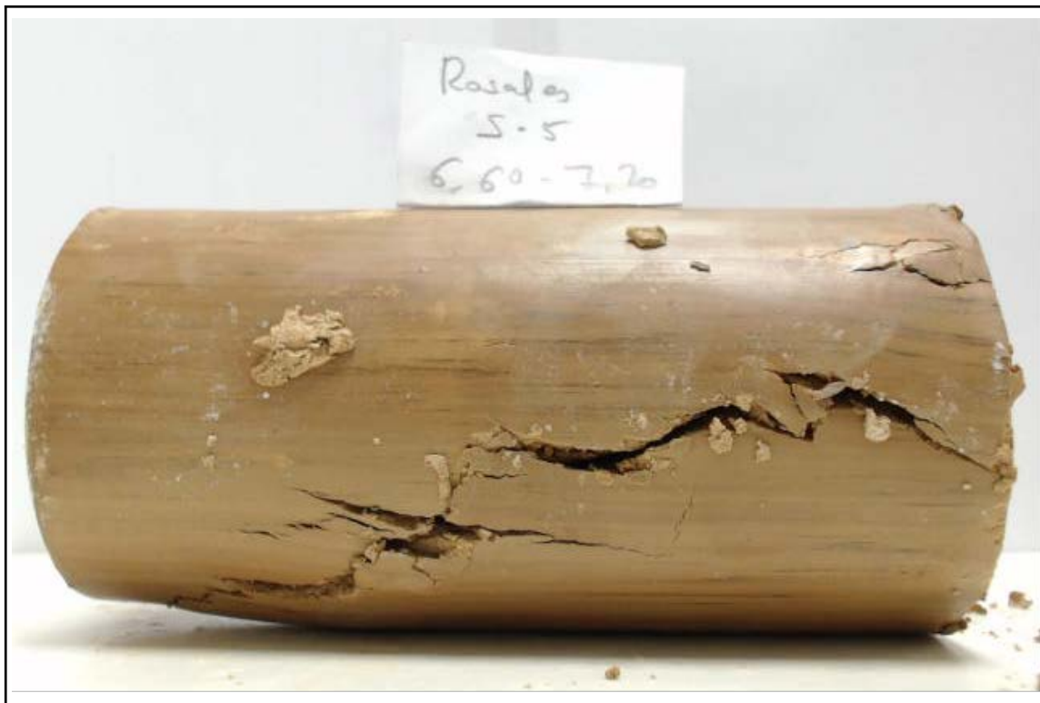
Probeta tras ensayo de compresión simple
