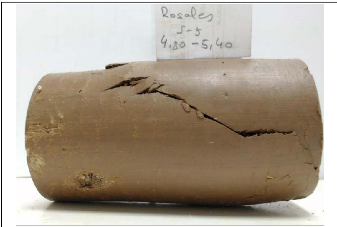
Probeta tras ensayo de compresión simple
